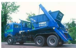
Camion portique (collecte d'une benne)
